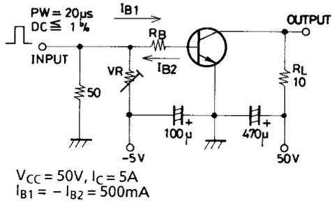
Unit (resistance :  $\Omega$ , capacitance : F)
