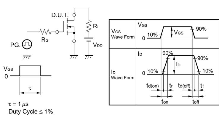
**TEST CIRCUIT 3 GATE CHARGE**
