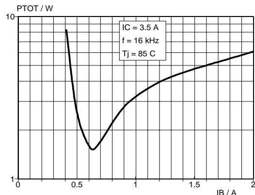
Fig.8. Limit  $P_{tot}$ ;  $T_j = 85^\circ\text{C}$
