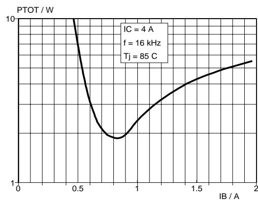
Fig.9. Limit  $P_{tot}$ ;  $T_j = 85^\circ\text{C}$
