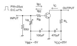
20IB1 = -20IB2 = IC = 500mA
