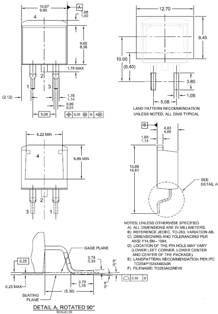
**Figure 23. TO-263 2L (D2PAK) - 2LD, TO263, SURFACE MOUNT**
