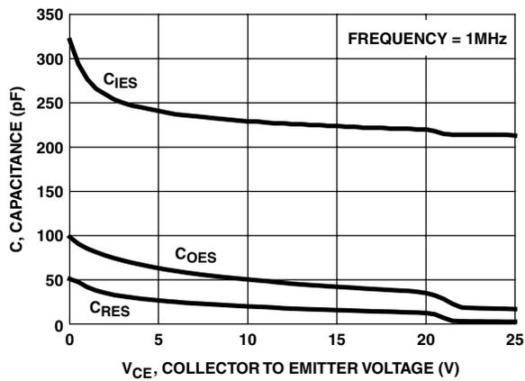
FIGURE 15. CAPACITANCE vs COLLECTOR TO EMITTER VOLTAGE
