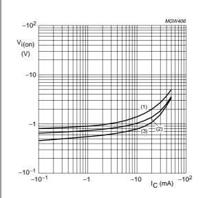
**TR2 (PNP);**  $V_{CE} = -0.3 \text{ V}.$
