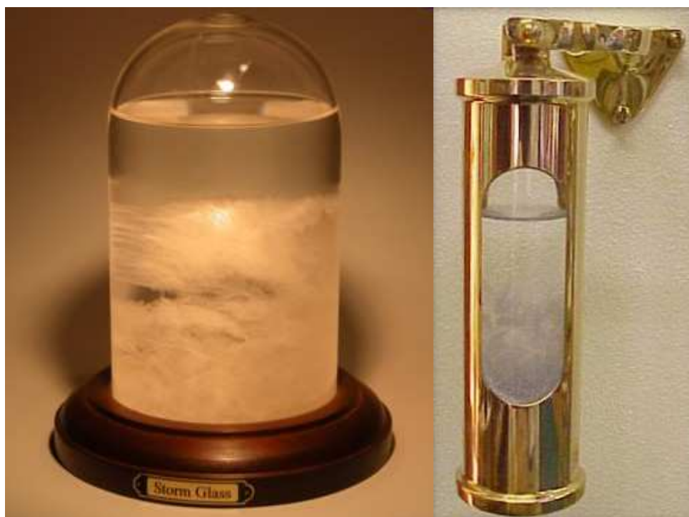
Przykłady rozwiązań współczesnych barometrów chemicznych. Źródło: internet.
